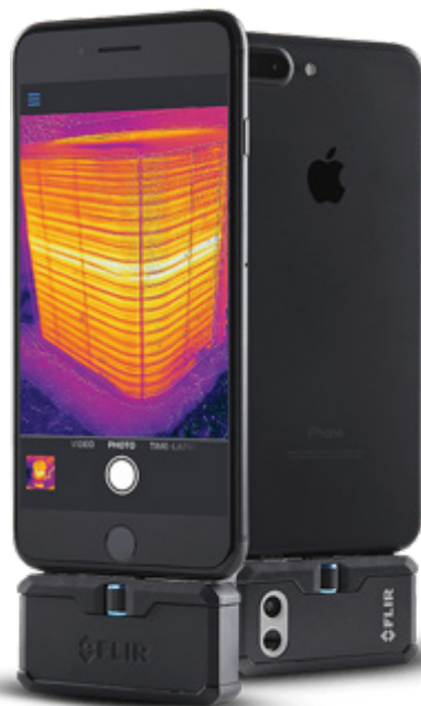
Figure 3. Le capteur externe Flir One est une caméra thermique qui pourrait estimer le statut hydrique de la vigne (source : Flir).
